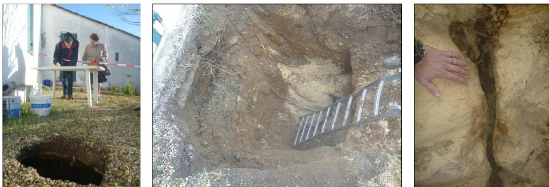
**Figure 12 :** Apparition d'un fontis à LATRESNE (Gironde) lié au débouffrage d'une fissure karstique (visible au fond derrière l'échelle) ayant entraîné les terrains superficiels [Source : Bureau des Carrières de Gironde]
